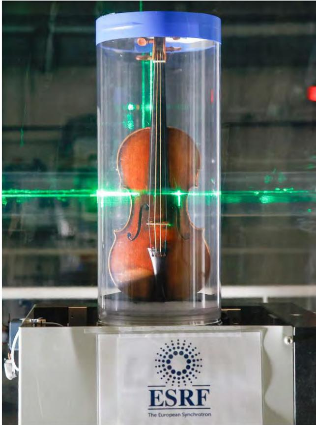
Analyse non destructive aux rayons X, par une nouvelle technique de microtomographie.
